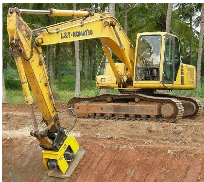
Рисунок 3.12 Вибротрамбовка на базе экскаватора
